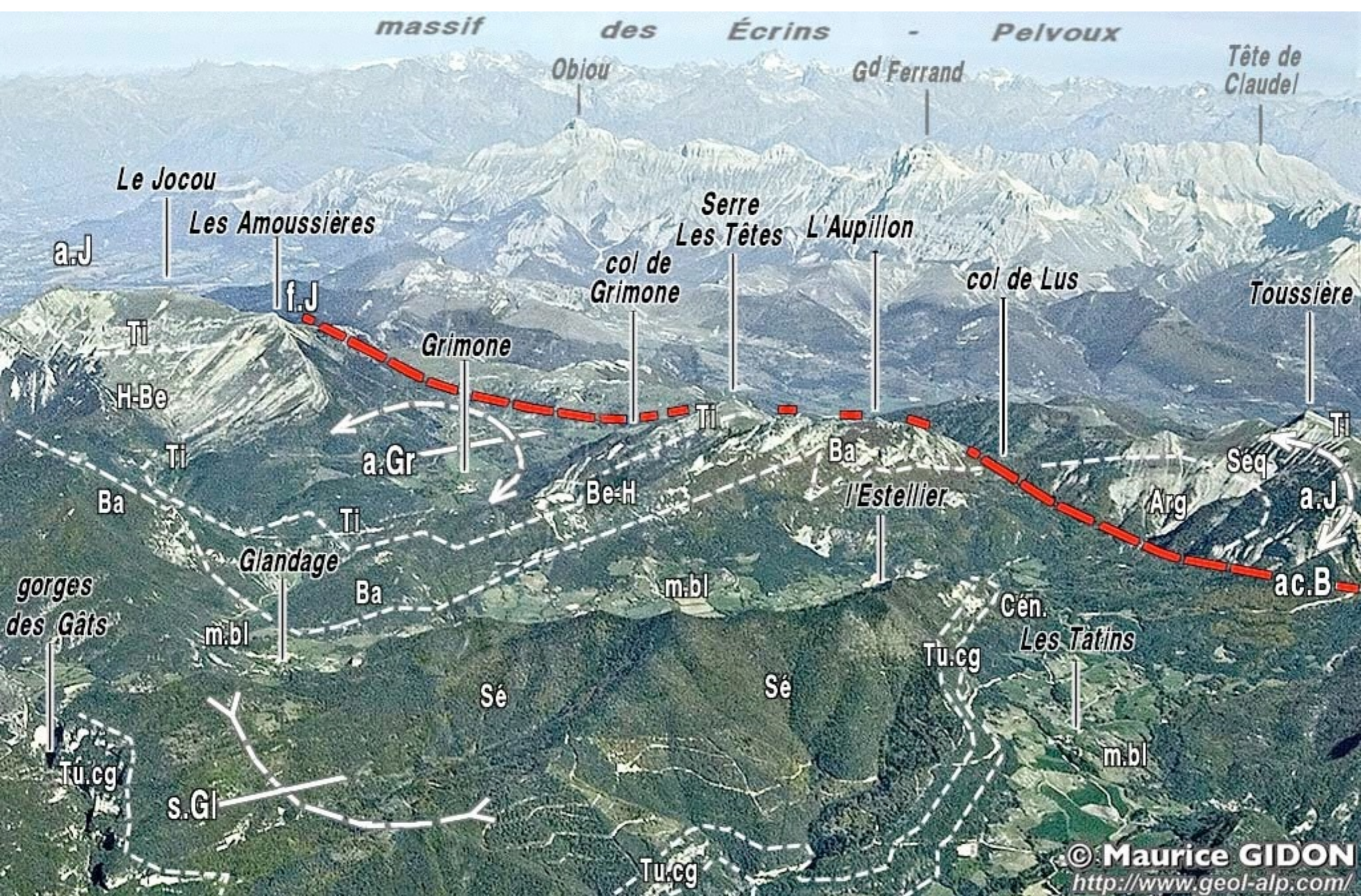
Limite Dévoluy-Diois : faille de Bonneval à la latitude de Lus et de Glandage
